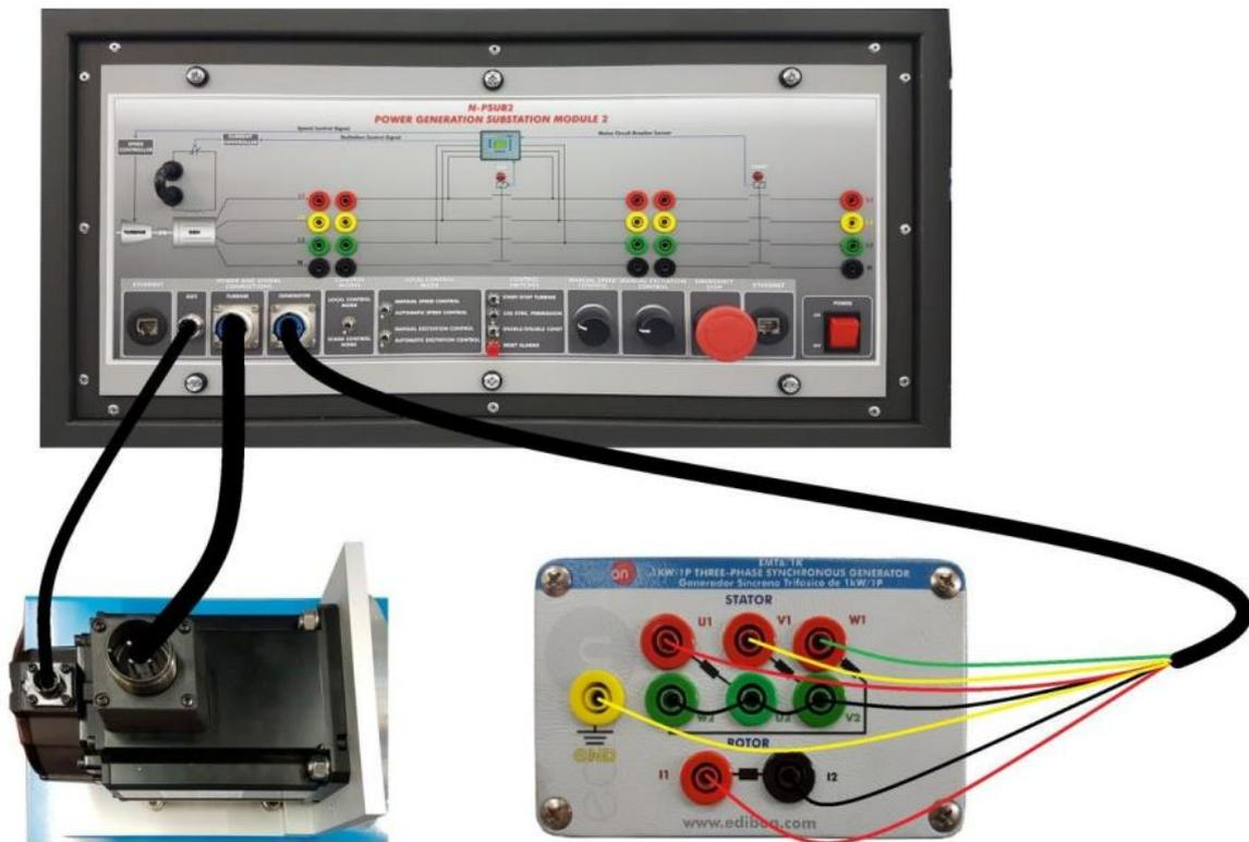
Figura 16: Cableado de alimentación de las máquinas eléctricas
