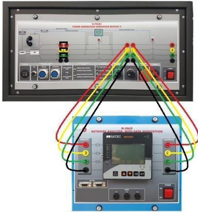
Figura 23: Cableado del analizador después del disyuntor 52G
