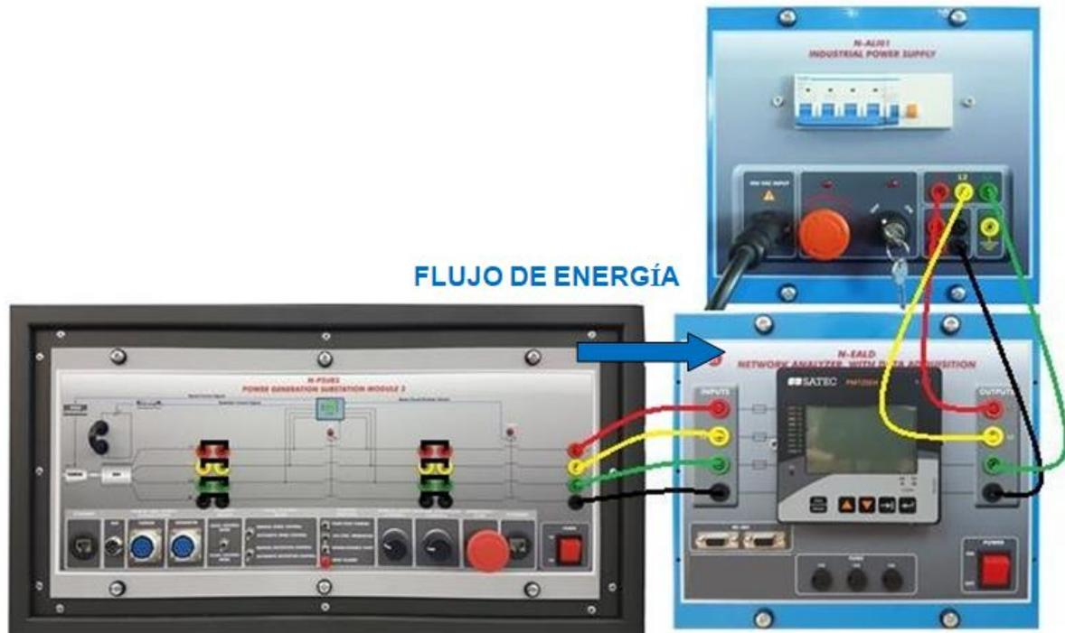
Figura 24: Cableado del analizador después del disyuntor 52NET
