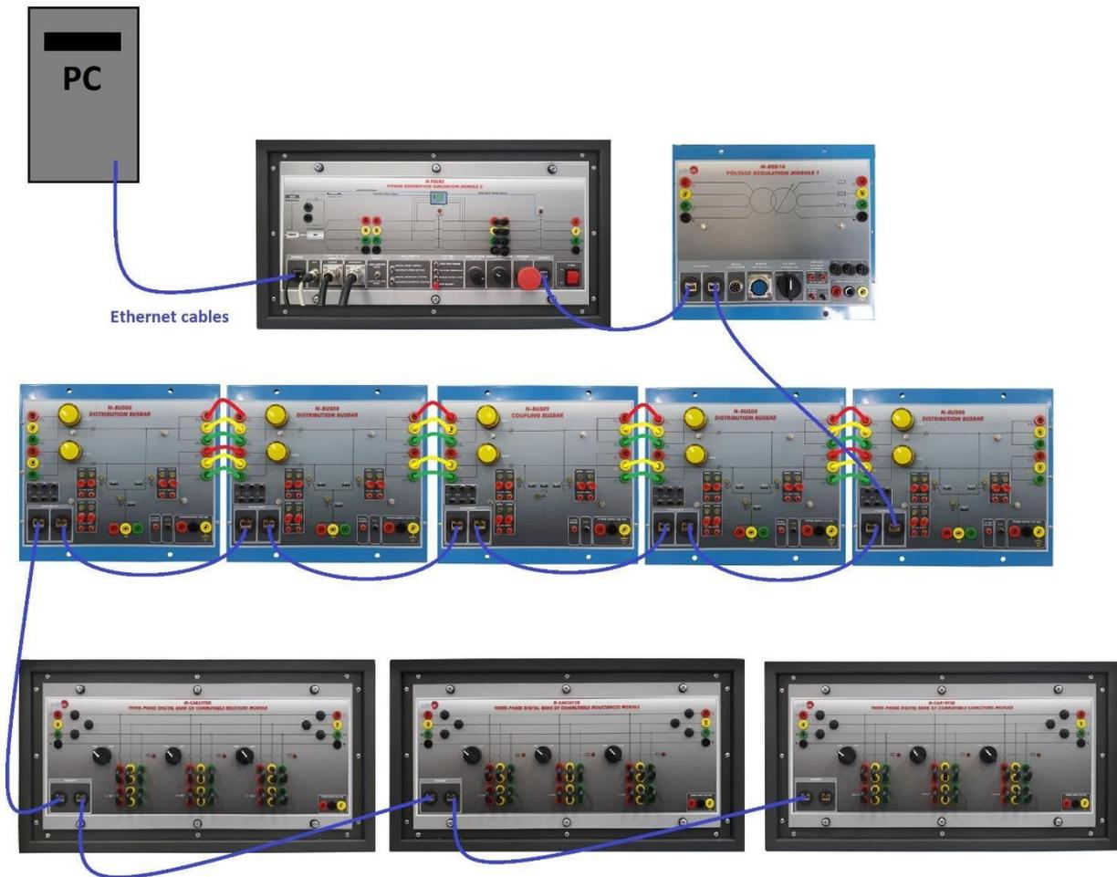
Figura 123: Ejemplo de conexión de cables Ethernet
