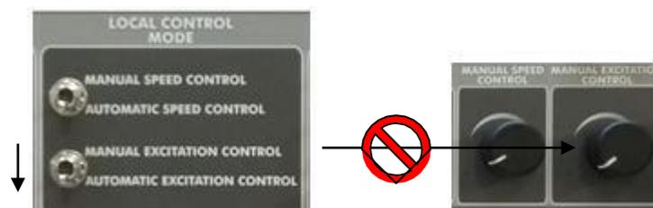
**Figura 47: control local / control automático de la excitación con potenciómetro**
