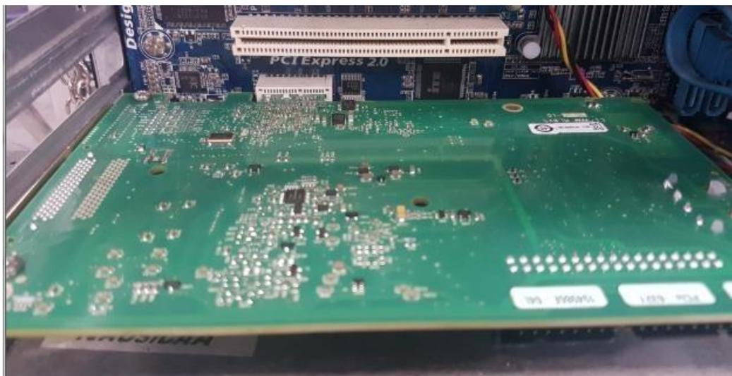
Figura 109: Conexión de la tarjeta PIC-EXPRESS
