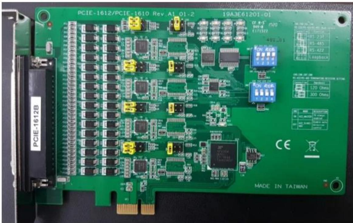
Figura 124: Tarjeta PCI de puertos COM
