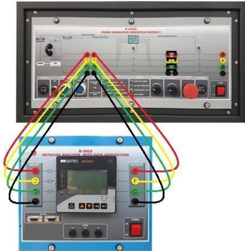
Figura 22: Cableado del analizador en la salida del generador (antes del disyuntor 52G)
