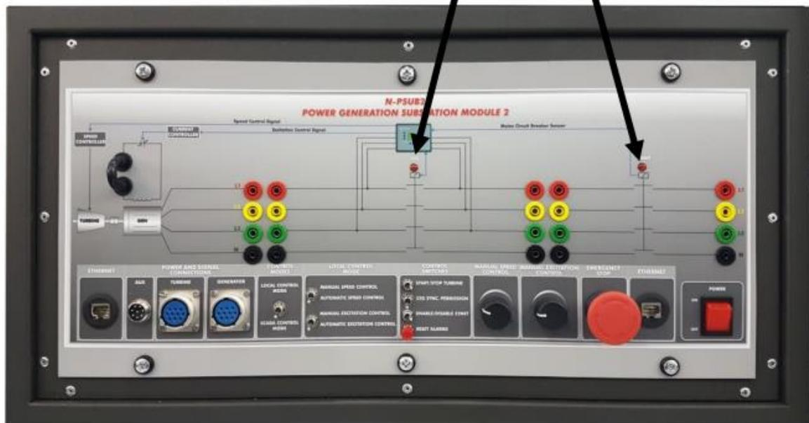
Figura 61: Relación entre el estado de los interruptores automáticos y el diagrama del controlador
